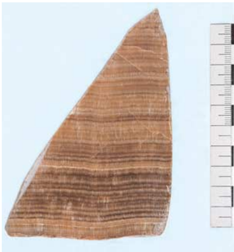
Abb. 36: Das in St. Maria im Kapitol zu Köln gefundene Kalksinterstück zeigt die schöne Bänderung des Materials, die uns auch als Datierungshilfe für die Betriebszeit der Leitung dient.
